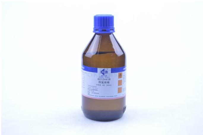
四氢呋喃 (tetrahydrofuran, THF)，又名氧杂环戊烷、1,4-环氧丁烷，化学式为  $C_4H_8O$ ，是呋喃的完全氢化产物。作为一种杂环醚类有机化合物，在常温常压下为无色透明、具有特征性乙醚气味的挥发性液体。其分子结构中的氧原子使其具备强极性，能与乙醇、烃类及卤代烃等大多数有机溶剂以任意比例互溶。该物质的主要风险源于其显著的物理与化学危险性：在物理危险性方面，THF 被归类为极度易燃液体（闪点-20℃），其蒸气与空气混合可形成宽广的爆炸极限范围（1.5% ~ 12.4%, V/V），遇高热、明火或氧化剂存在下，极易引发燃烧甚至爆炸，且蒸气可沿地面扩散至远处火源并造成回燃。在化学危险性方面，THF 分子中的  $\alpha$ -H 使其在接触空气或光照时易于发生自氧化反应，生成不稳定的有机过氧化物，这些过氧化物在浓缩、加热或受机械冲击时可发生剧烈分解或爆炸。此外，THF 还能与锂、铝等活泼金属及其合金发生剧烈反应。
